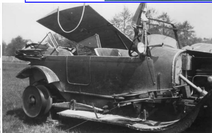
Sous l'aile du Sablier 20, la voiture Voisin 23 cv transformée en treuil pour Vol à Voile. Photo Paul Jamin
