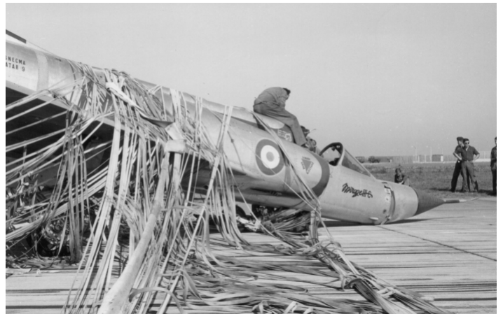
Un Mirage IIIC pouvait s'arrêter en 275 m avec la barrière. Celui-ci a mal supporté d'être freiné de cette manière : train avant et nez du radar Cyrano pliés.
