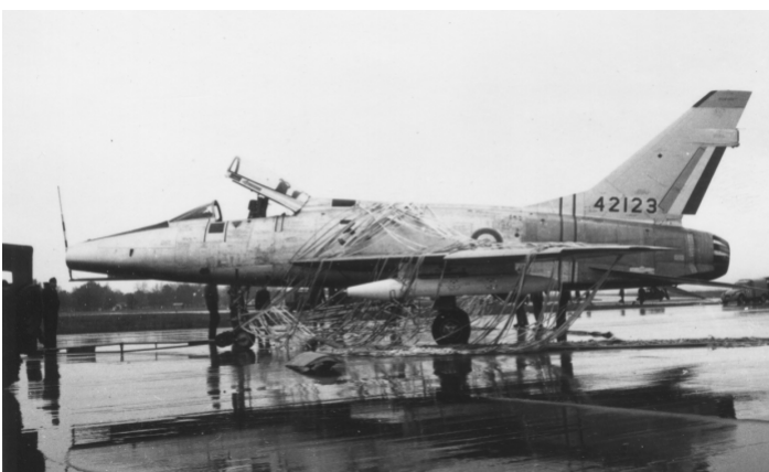
Le F-100 Super-Sabre n°42123 de la 3ème Escadre de Chasse après avoir engagé la barrière. La perche n'est pas cassée, elle est juste pliable.
