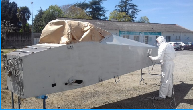
Application de la peinture d'apprêt sur le fuselage du RL-19 à l'atelier des «Aéroplanes» à St-Pazanne .
