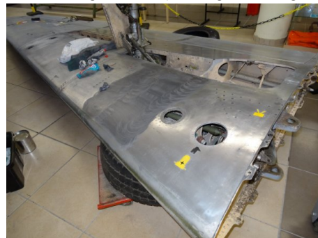
Polissage de l'intrados après assemblage du train d'atterrissage
