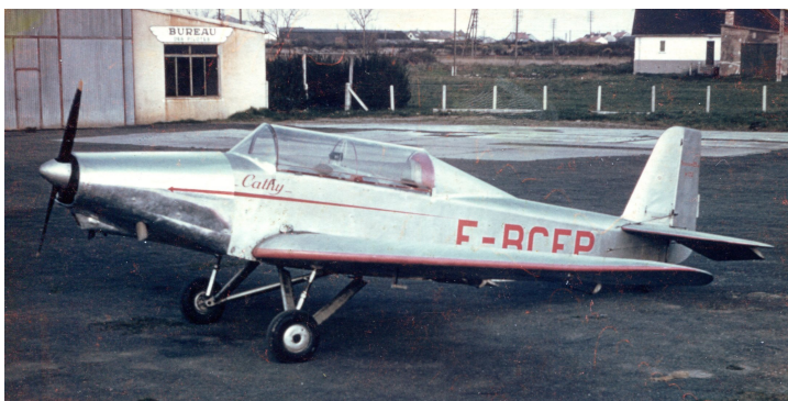
Le Mauboussin après modification en conduite intérieure et avec le nouveau moteur Continental A-65
