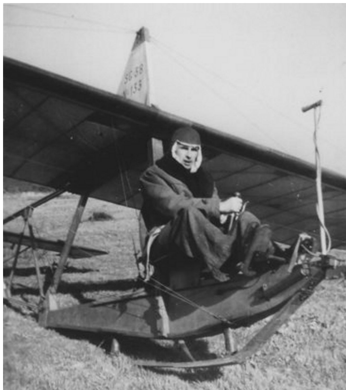
René Fillonneau sur le SG-38 n° 133. Notez l'antenne pitot pour l'indicateur de vitesse, seul instrument de l'appareil. Photo Fillonneau
