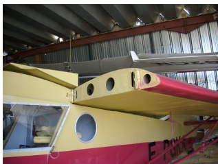
Une option permet le repliage des ailes le long du fuselage (comme pour les Potez 36, 43 ou 58) d'avant guerre.
