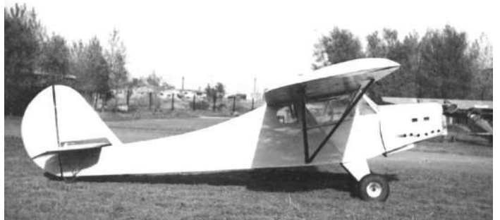
La version allégée « RA-14 Spécial » a reçu un moteur Train puis Continental 65 cv. Sous l'immatriculation F-PCDR, cet exemplaire unique a volé pour la Ligue Aéronautique de Saumur à la grande satisfaction de ses pilotes. (photo de 1946, archives Espace Air Passion)
