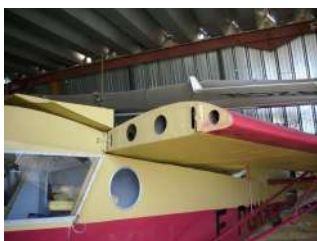
Une option permet le repliage des ailes le long du fuselage (comme pour les Potez 36, 43 ou 58) d'avant guerre.
