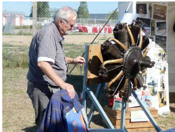
Jean-François explique le fonctionnement du moteur rotatif Le Rhône 9C.
