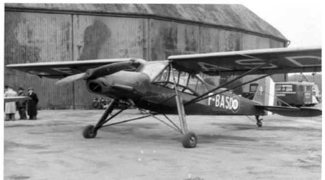
Morane-Saulnier MS-500 S N° 1003 F-BASD sorti d'usine le 16/01/1946, version sanitaire, moteur Argus AS 10 C N° 444703. Le nom de Sgt chef Redor se distingue sous la cabine sur agrandissement de la photo. Photo famille Loreau
