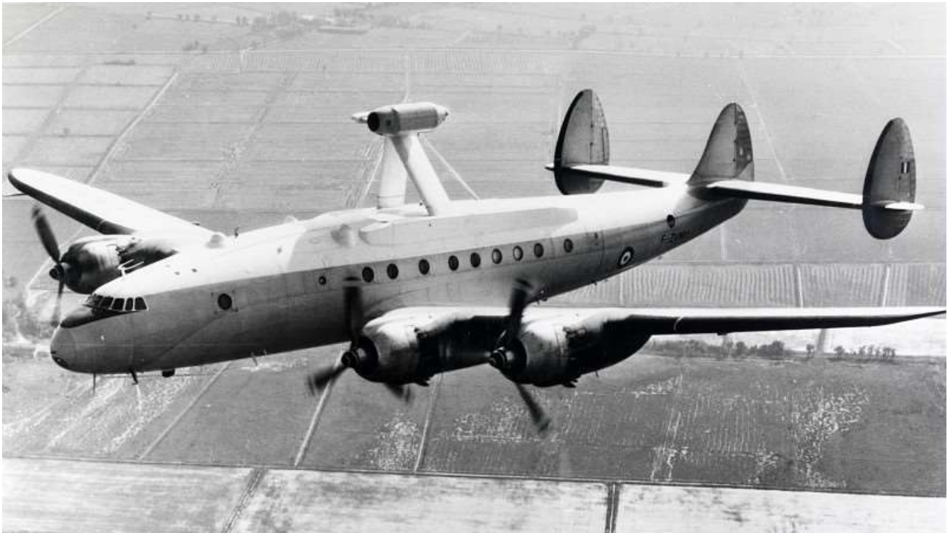
le "Constellation" F-ZVMV en vol avec le moteur Snecma "Larzac"
