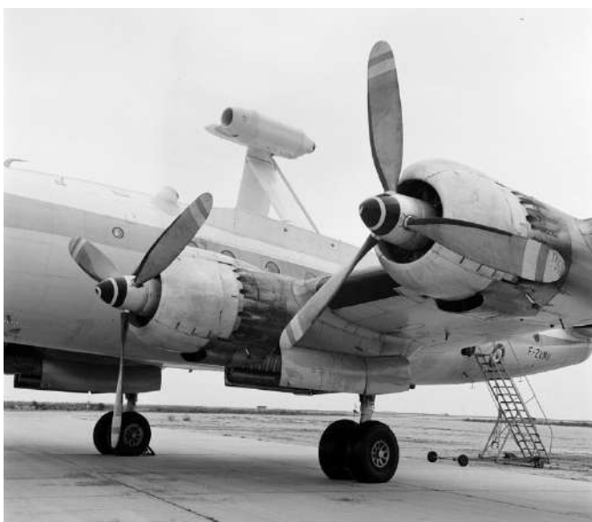
moteur Snecma "Larzac" sur le "Constellation" F-ZVMV
