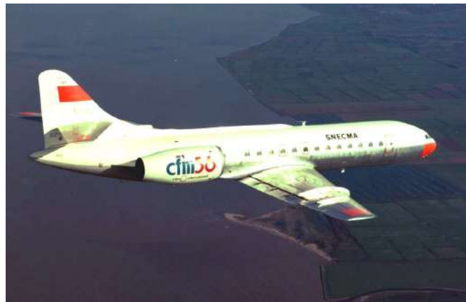
CFM56-2 sur banc d'essais volant « Caravelle » photo © Espace Patrimoine Safran
