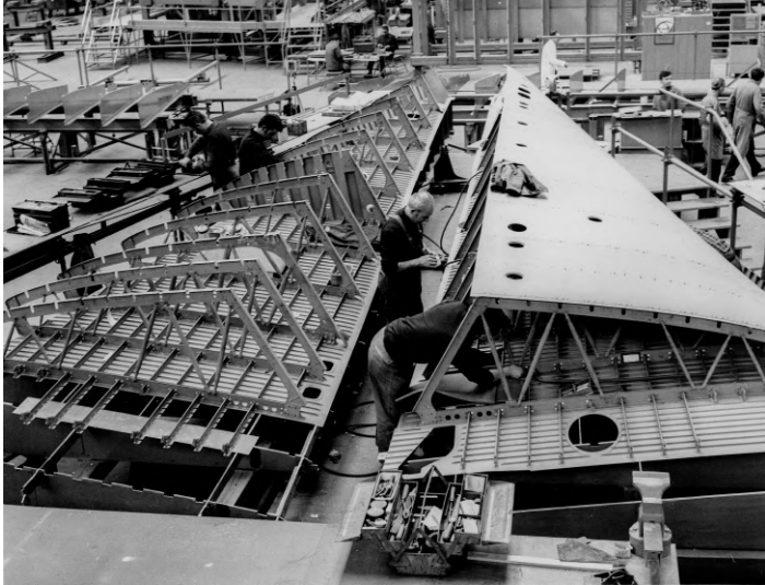
tronçon Tr13 de Concorde gauche et droit en assemblage à l'usine Sud Aviation de Bouguenais. Photo Sud Aviation
