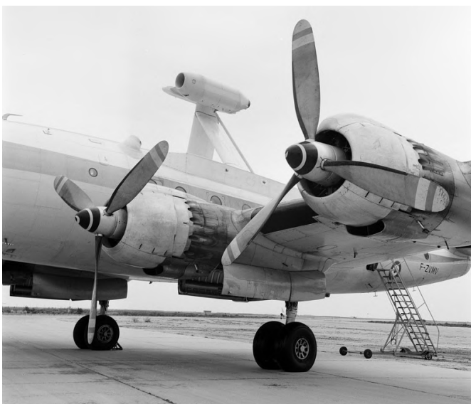
moteur Snecma "Larzac" sur le "Constellation" F-ZVMV photo © Espace Patrimoine Safran
